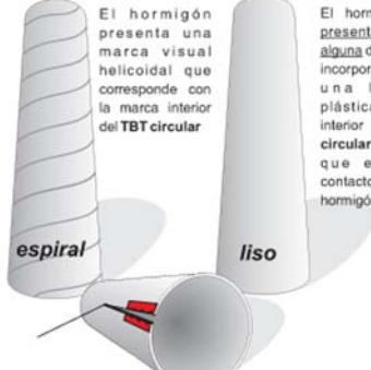
El hormigón no presenta marca alguna debido a la incorporación de una lámina plástica en el interior del TBT circular que es la que está en contacto con el hormigón.
